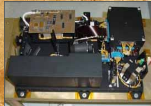
SPICAM: UV and IR Spectrometer PI: F. Montmessin, Latmos Paris (FR)
