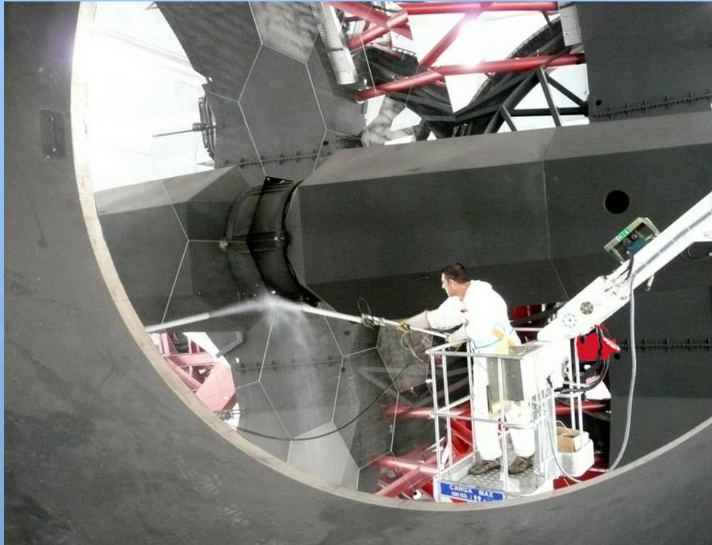
CO<sub>2</sub> líquido a alta presión fluye por una manguera y sufre un cambio de presión a  $P_{\text{atmosférica}}$  y se expande sin intercambio de calor → Mezcla de CO<sub>2</sub> gaseoso y nieve carbónica. Estos copos de nieve inciden sobre la superficie óptica. **SNO GUN-II (Va-Tran Systems)**
