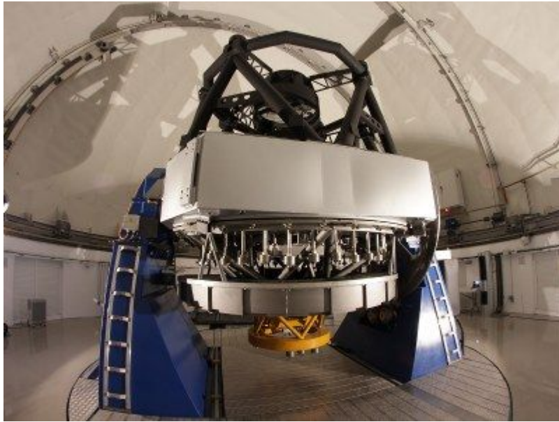
T250 - Altazimutal - M1 2.55m
